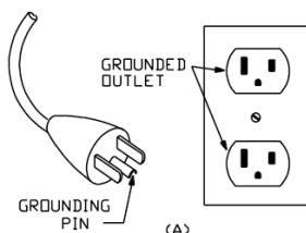
Verwenden Sie ausschließlich dreipolare Verlängerungsleitungen mit Schutzkontaktstecker und dreipolare Steckdosen für den Anschluss des Geräts. Vergewissern Sie sich, dass die Verlängerungsleitung keine Beschädigung aufweist. Verwenden Sie nur ausreichend dimensionierte Verlängerungsleitungen. Für Längen unter \_\_\_\_ ft, \_\_\_\_ sind AWG-Verlängerungsleitungen zu verwenden. Zu schwach dimensionierte Kabel führen zu Spannungsverlusten und einer Erhitzung der Kabel.
