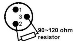
connecteur XLR à 3 broches, veuillez utiliser le câble adaptateur de sortie DMX (câble IP vers XLR femelle) pour réaliser la connexion.
