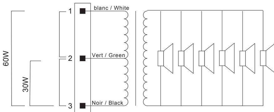
La puissance et l'impédance de la colonne CLS660 sont déterminées par le câblage.
