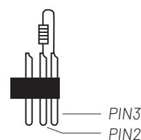
Bei Verwendung des Standard-DMX512-Steuerungssignals muss die Ausgangsschnittstelle des letzten Geräts mit einem DMX-Stecker verbunden sein. Dieser Stecker setzt einen 120-Ohm-Widerstand zwischen den 2 Pins und 3 Pins des "Canon"-Steckers ein. Wie im folgenden Bild gezeigt. Wenn Sie diesen Stecker in die Ausgangsschnittstelle des letzten Geräts stecken, wird dies Interferenzen während des Signalübertragungsprozesses vermeiden.
