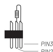
En uso profesional, la norma DMX512 requiere la presencia de un 'tapón DMX' en el último dispositivo DMX de la cadena para finalizar correctamente el bucle de señal. Este tapón está compuesto por una resistencia de 120 ohmios colocada entre el pin 2 y el pin 3 del conector XLR.
