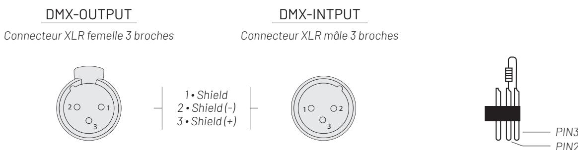
En utilisation professionnelle, la norme DMX512 impose la présence d'un «bouchon DMX» sur le dernier appareil DMX de la chaîne afin de finaliser correctement la boucle de signal. Ce bouchon est constitué d'une résistance de 120 ohms placée entre la broche 2 et la broche 3 du connecteur XLR.
