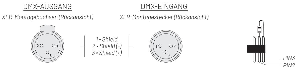
In professionellen Anwendungen schreibt der DMX512-Standard vor, dass am letzten DMX-Gerät in der Kette ein "DMX-Terminator" vorhanden sein muss, um die Signalloop korrekt abzuschließen. Dieser Terminator besteht aus einem 120-Ohm-Widerstand, der zwischen Pin 2 und Pin 3 des XLR-Steckers platziert ist.
