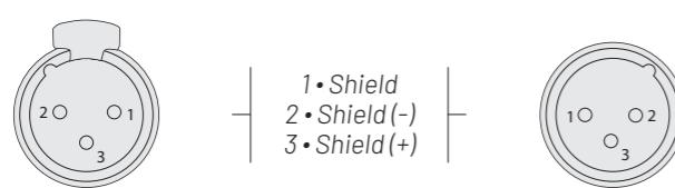
En uso profesional, la norma DMX512 requiere la presencia de un 'tapón DMX' en el último dispositivo DMX de la cadena para finalizar correctamente el bucle de señal. Este tapón está compuesto por una resistencia de 120 ohmios colocada entre el pin 2 y el pin 3 del conector XLR.
