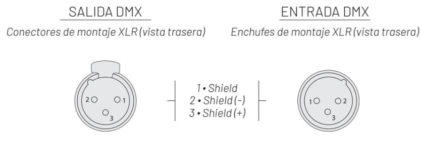
En uso profesional, la norma DMX512 requiere la presencia de un 'tapón DMX' en el último dispositivo DMX de la cadena para finalizar correctamente el bucle de señal. Este tapón está compuesto por una resistencia de 120 ohmios colocada entre el pin 2 y el pin 3 del conector XLR.
