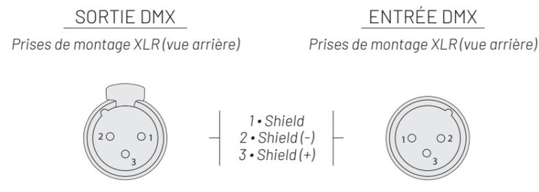
En utilisation professionnelle, la norme DMX512 impose la présence d'un « bouchon DMX » sur le dernier appareil DMX de la chaîne afin de finaliser correctement la boucle de signal. Ce bouchon est constitué d'une résistance de 120 ohms placée entre la broche 2 et la broche 3 du connecteur XLR.
