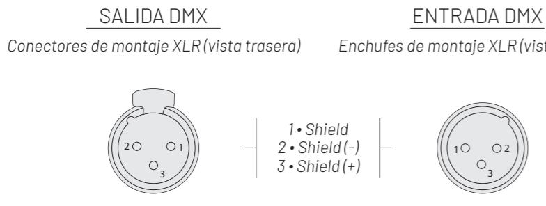
En uso profesional, la norma DMX512 requiere la presencia de un 'tapón DMX' en el último dispositivo DMX de la cadena para finalizar correctamente el bucle de señal. Este tapón está compuesto por una resistencia de 120 ohmios colocada entre el pin 2 y el pin 3 del conector XLR.
