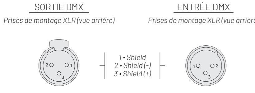
En utilisation professionnelle, la norme DMX512 impose la présence d'un «bouchon DMX» sur le dernier appareil DMX de la chaîne afin de finaliser correctement la boucle de signal. Ce bouchon est constitué d'une résistance de 120 ohms placée entre la broche 2 et la broche 3 du connecteur XLR.
