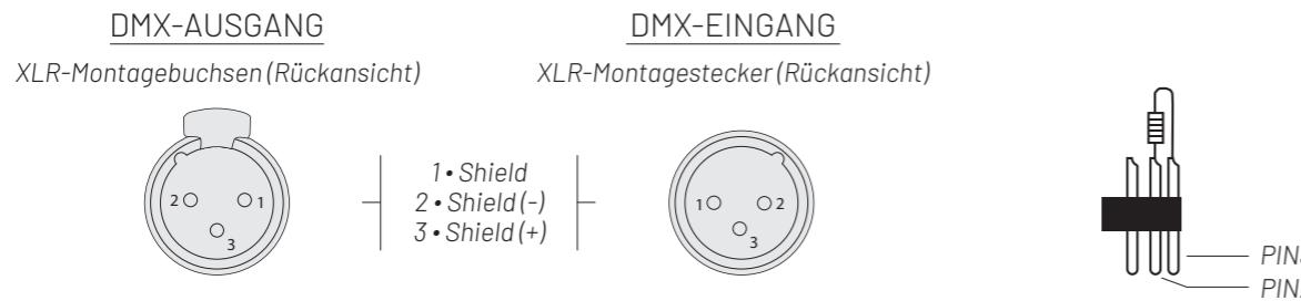
Bei Verwendung des Standard-DMX512-Steuerungssignals muss die Ausgangsschnittstelle des letzten Ger ts mit einem DMX-Stecker verbunden sein. Dieser Stecker setzt einen 120-Ohm-Widerstand zwischen den 2 Pins und 3 Pins des "Canon"-Steckers ein. Wie im folgenden Bild gezeigt. Wenn Sie diesen Stecker in die Ausgangsschnittstelle des letzten Ger ts stecken, wird dies Interferenzen w hrend des Signal bertragungsprozesses vermeiden.
