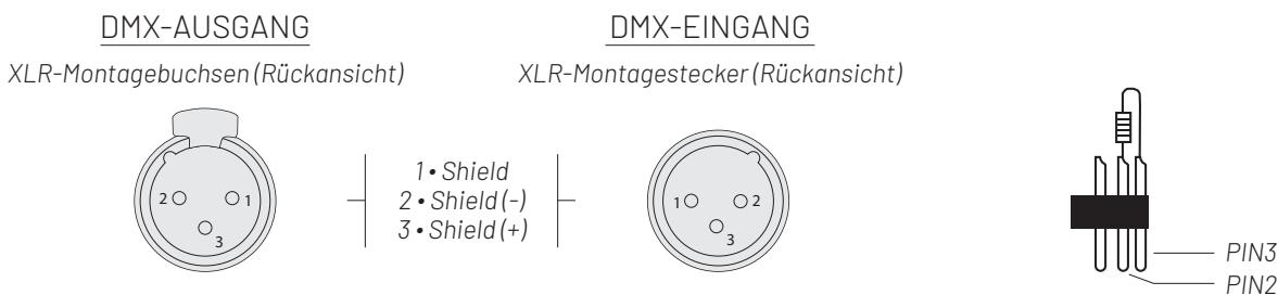
In professioneller Anwendung erfordert der DMX512-Standard die Anwesenheit eines „DMX-Abschlusssteckers“ am letzten DMX-Gerät in der Kette, um die Signalschleife korrekt zu beenden. Dieser Stecker besteht aus einem 120-Ohm-Widerstand, der zwischen Pin 2 und Pin 3 des XLR-Steckers platziert wird.
