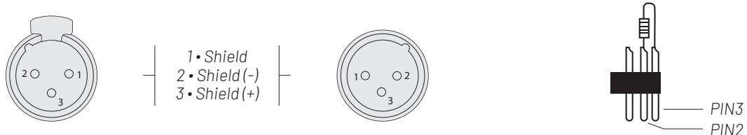
En uso profesional, la norma DMX512 requiere la presencia de un "tapón DMX" en el último dispositivo DMX de la cadena para finalizar correctamente el bucle de señal. Este tapón consta de una resistencia de 120 ohmios colocada entre el pin 2 y el pin 3 del conector XLR.
