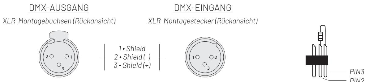
In der professionellen Nutzung erfordert der DMX512-Standard, dass am letzten DMX-Gerät in der Kette ein "DMX-Terminator" vorhanden ist, um die Signaloop korrekt abzuschließen. Dieser Terminator besteht aus einem 120-Ohm-Widerstand, der zwischen Stift 2 und Stift 3 des XLR-Anschlusses platziert wird.
