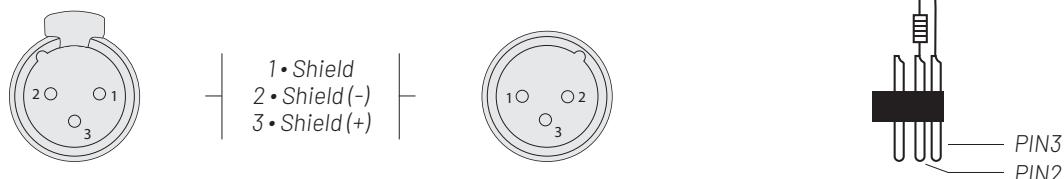
En utilisation professionnelle, la norme DMX512 impose la présence d'un «bouchon DMX» sur le dernier appareil DMX de la chaîne afin de finaliser correctement la boucle de signal. Ce bouchon est constitué d'une résistance de 120 ohms placée entre la broche 2 et la broche 3 du connecteur XLR.
