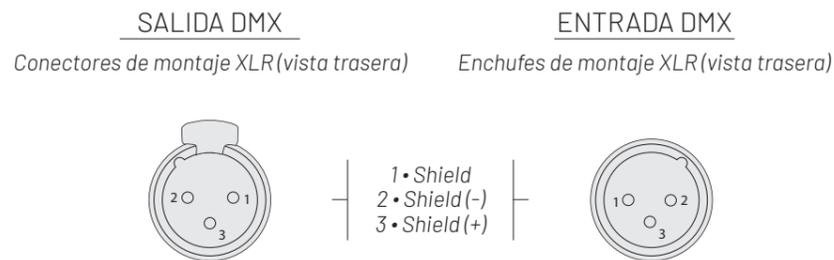
En uso profesional, la norma DMX512 requiere la presencia de un 'tapón DMX' en el último dispositivo DMX de la cadena para finalizar correctamente el bucle de señal. Este tapón está compuesto por una resistencia de 120 ohmios colocada entre el pin 2 y el pin 3 del conector XLR.
