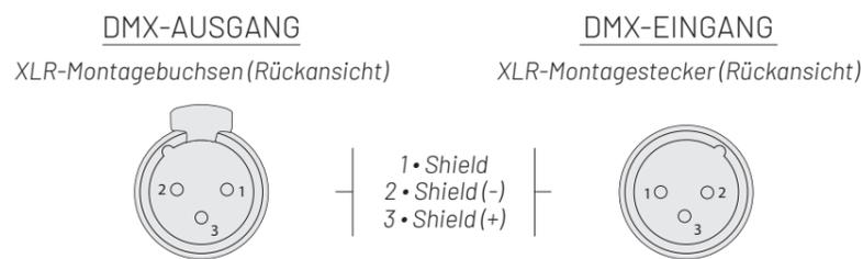
In professionellen Anwendungen schreibt der DMX512-Standard vor, dass am letzten DMX-Gerät in der Kette ein "DMX-Terminator" vorhanden sein muss, um die Signalloop korrekt abzuschließen. Dieser Terminator besteht aus einem 120-Ohm-Widerstand, der zwischen Pin 2 und Pin 3 des XLR-Steckers platziert ist.
